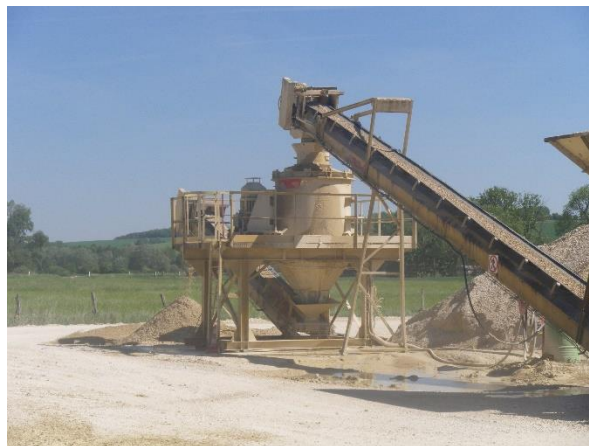
Figure 11 : Trémie de chargement et concasseur giratoire (ENCEM)
