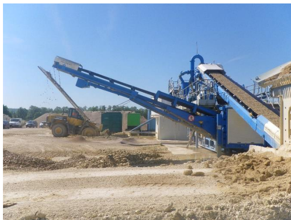
Figure 6 : Installation de concassage – criblage et lavage du site de Lanty-sur-Aube (ENCEM)
