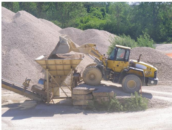
Figure 11 : Trémie de chargement et concasseur giratoire (ENCEM)
