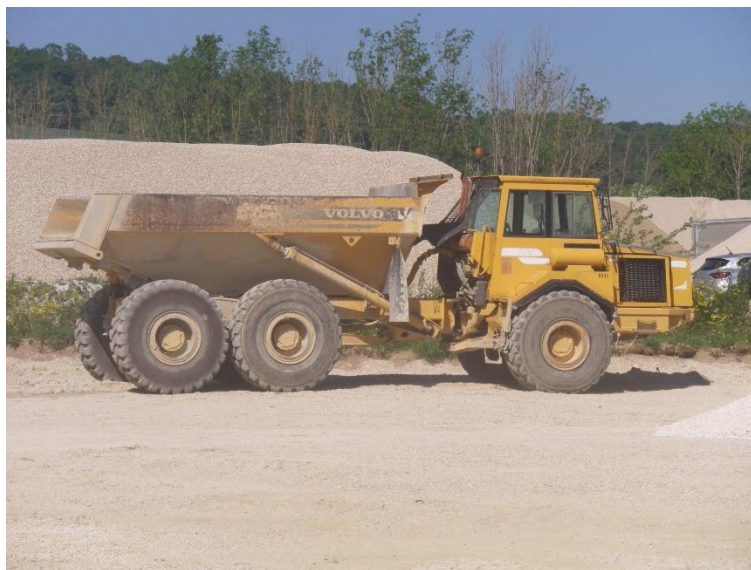
Figure 4 : Tombereau articulé utilisé pour l'approche du tout-venant alluvionnaire (ENCEM)
