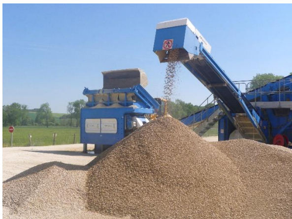
Figure 6 : Installation de concassage – criblage et lavage du site de Lanty-sur-Aube (ENCEM)
